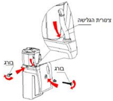
8. סגור את הברגים, שים לב לא סגור חזק מדי הדבר יכול לגרום נזק (שבר) לפורק
